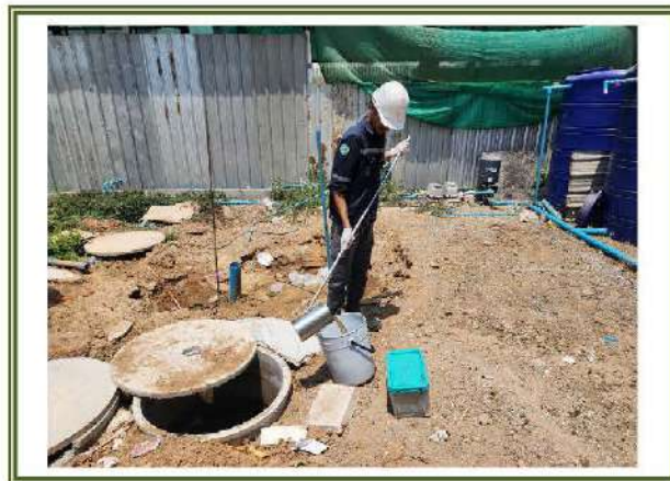
รูปที่ 3-14 คุณภาพน้ำทิ้ง บริเวณบ่อพักน้ำทิ้งหลังผ่านการบำบัดจาก ระบบบำบัดน้ำเสีย
