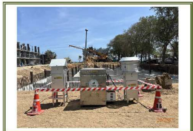
รูปที่ 3-3 การตรวจวัดคุณภาพอากาศในบรรยากาศ บริเวณทิศเหนือของพื้นที่โครงการ
